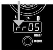
5. Установить генератор в режим синхронизации через радиоканал. Для этого необходимо нажать кнопку «Head/Model» («Головка/пилотный свет») D [12], пока на месте второго символа на дисплее уровня энергии D [10] не появится символ «r» (см. рисунок ниже). (Если выбран символ «c», синхронизация через радиоканал не включена.)
